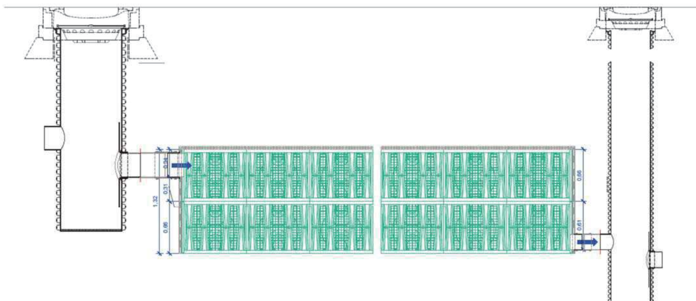
Figure 9b – Coupe de principe d'un bassin réalisé avec Rigofill ST (regards externes)
