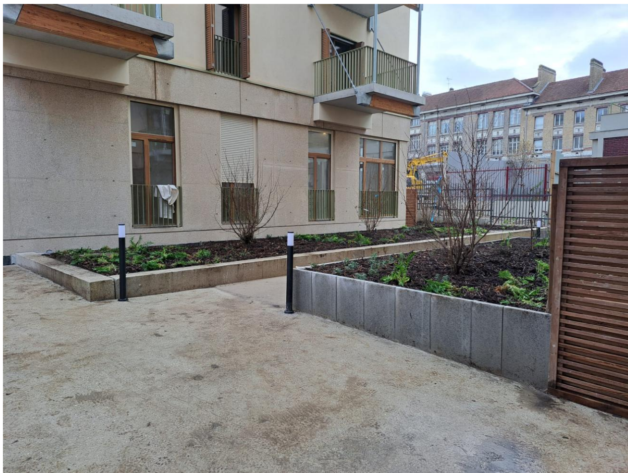
Exemples de Jardin de Pluie Urbain en pied de bâtiment – récupération des EP de toiture
