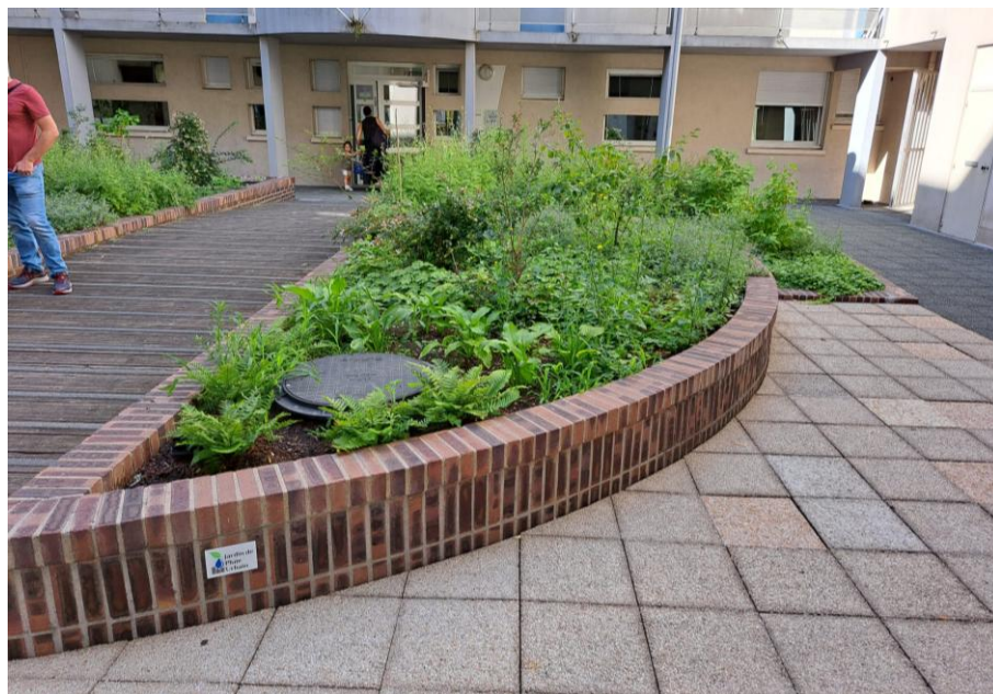
Exemples de Jardin de Pluie Urbain intégré à la structure au sol existante
