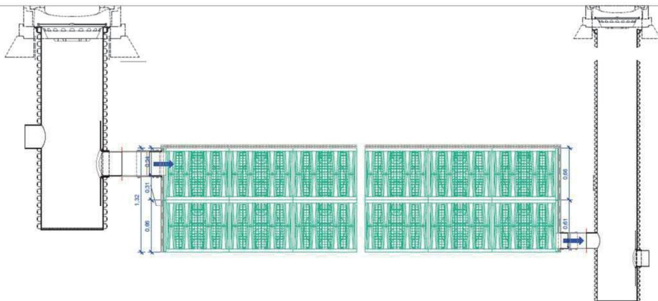
Figure 9b – Coupe de principe d'un bassin réalisé avec Rigofill ST (regards externes)
