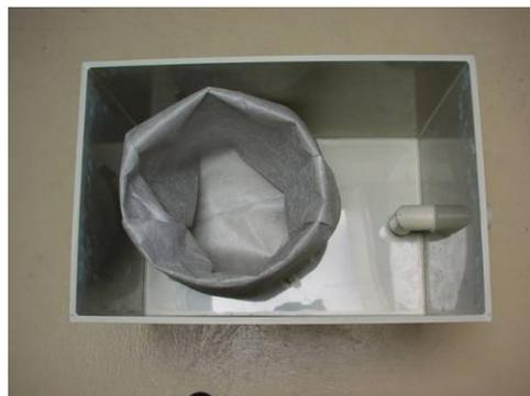
Per eseguire una flocculazione, basta aggiungere una polvere (flocculante) nell'acqua da trattare, agitare per alcuni minuti e, una volta che si sono formati i fiocchi, far passare l'acqua attraverso il filtro. Questa operazione richiede circa cinque minuti. La dose media di polvere utilizzata è di circa 100 grammi per 100 litri di acqua da trattare.
