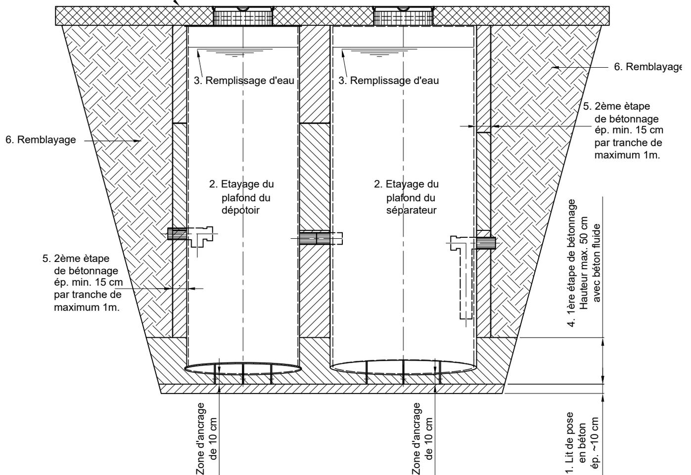
UN ETAYAGE DU PLAFOND DE LA FOSSE DOIT POUVOIR REPRENDRE LA PRESSION DU BETON
