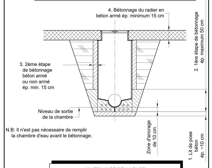
UN ETAYAGE DE LA FACE SUPERIEURE DOIT POUVOIR REPRENDRE LA PRESSION DU BETON
