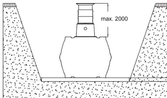
Hauteurs de recouvrement avec rehausse télescopique en fonte - passage véhicules (charge max. 3,5 t).
