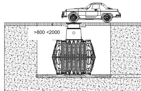
Hauteurs de recouvrement avec rehausse télescopique passage camions ou en fonte (avec anneau béton et couvercle – non fournis) - passage camions (charge max. 12 t).
