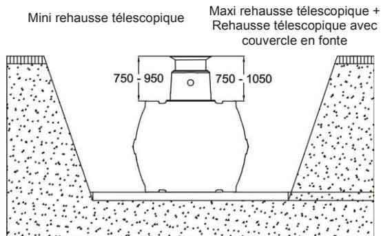
Hauteur de recouvrement maximale avec 2 rallonges et rehausse télescopique.
