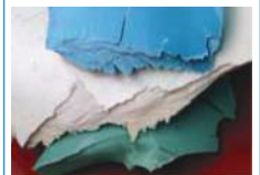
L'immagine mostra il PVC di struttura amorfa (colore verde) e il PVC di struttura lamellare ottenuta grazie al processo di PVC-Orientato molecolare (colore azzurro) When an amorphous structure PVC (the lower section, green in color) is subjected to molecular orientation, it adapts a laminar structure (upper section, blue in color).
