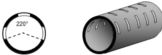
Illustration 21 –Tuyau de drainage partiel (220°)
