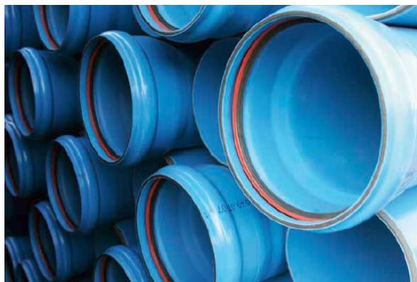
— Grâce à la continuité dans la structure lisse et renforcée des tubes et des raccords, la **déformation à long terme** des tubes 'HSK', même avec de faibles couvertures et de fortes charges roulantes, ou dans le cas de fortes couvertures, ne dépasse pas les 3 à 4%.
