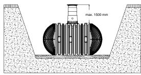
Überdeckungshöhen mit Teleskop Domschacht Guss (mit Gussabdeckung Klasse B) im PKW befahrenen Bereich (Belastung bis 3,5 t).
