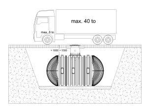
Die Tanks dürfen nur bedingt ins Grundwasser eingebaut werden. Ist zu erwarten, dass Grundwasser auch nur gelegentlich höher ansteigt, als in der nebenstehenden Abbildung gezeigt, ist dieses durch eine Drainage abzuleiten.
