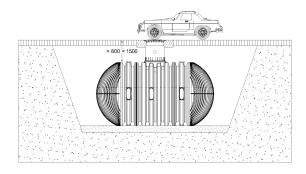
Überdeckungshöhen mit Teleskop Domschacht LKW (Abdeckung Klasse D – bauseits zu stellen) im LKW befahrenen Bereich (Belastung bis 40 t).
