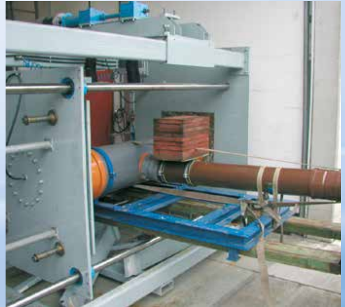
Montage de l'essai de compression
