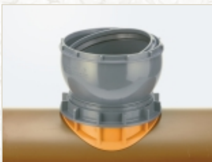
CONNEX-Anschluss DN/OD 160/162 an HS®-Kanalrohr, Bohrung 162 ± 1 mm
