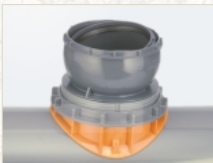
CONNEX-Anschluss DN/OD 160/200 an CONNEX-Kanalrohr, Bohrung 200 ± 1 mm
