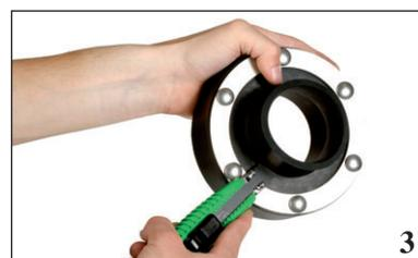
Con un cutter tagliare l'anello inserito e la guarnizione è pronta per essere montata.
