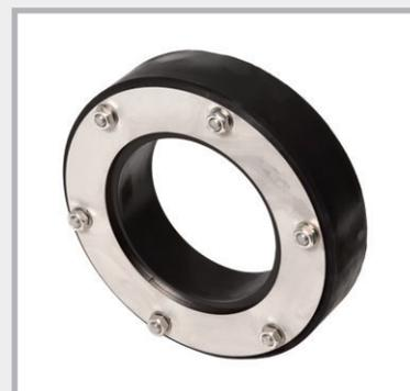
**Montaggio:** Dopo aver inserito il manicotto di protezione per tubi e aver fatto passare il tubo interno, le viti vengono avvitate a croce. Serrare ogni vite compiendo più giri affinché l'anello di tenuta si comprima in modo uniforme. Coppia massima M6 = 5 Nm, M8 = 10 Nm, M10 = 15 Nm, M12 = 20 Nm. Serrare di nuovo dopo 2 - 3 ore.
