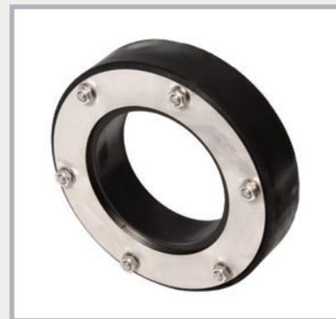
**Einbau:** Nach dem Einlegen der Ringraumdichtung und dem Durchführen des Mediumrohres werden die Schrauben über Kreuz angezogen. Jede Schraube mehrmals um eine Umdrehung anziehen, damit sich der Dichtring gleichmäßig auspresst. Maximales Drehmoment M6 = 5 Nm, M8 = 10 Nm, M10 = 15 Nm, M12 = 20 Nm. Nach 2 - 3 Stunden noch einmal nachziehen.
