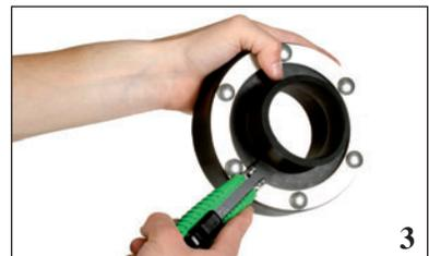
Mit einem Cutter schneiden Sie den durchgeschobenen Ring ab und die Dichtung ist fertig für den Einbau.
