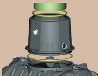
**Étanche jusqu'à la surface du sol** : les joints rendent la cuve totalement étanche, évitant toutes les infiltrations d'eau ou de saletés susceptibles de polluer l'eau dans la cuve. Le premier joint d'étanchéité est placé entre la cuve et le dôme, le deuxième, entre le dôme et la réhausse télescopique. Tout le réseau de raccordement est rendu étanche grâce aux cinq ouvertures pré-découpées sur le dôme, qui sont équipées de joints à lèvres.
