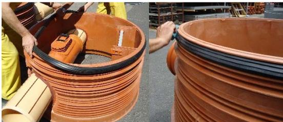
**Bild 4 :** Gummidichtung wird eingelegt
