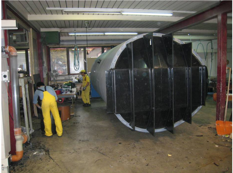
Schacht mit schrägem verstärktem Boden (zur Montage im Grundwasserbereich)
