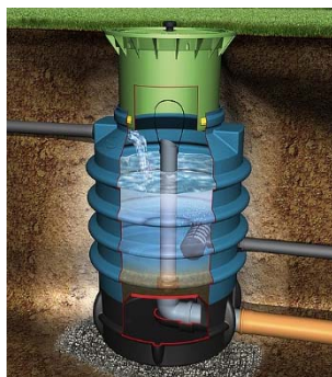
Pozzetto di captazione
