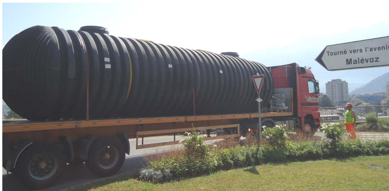
Immagine 1 : Serbatoio da 42.000 litri
