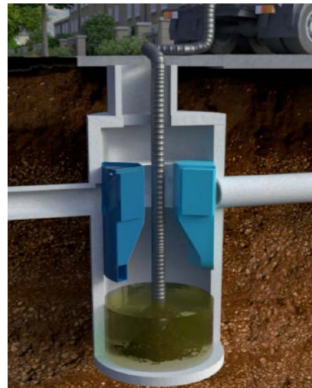
Figura 2 : Aspirazione dei fanghi
