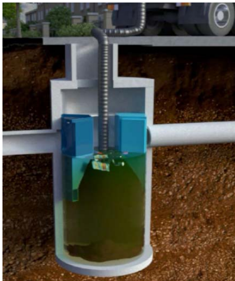
Figura 1 : Aspirazione di liquidi galleggianti e leggeri
