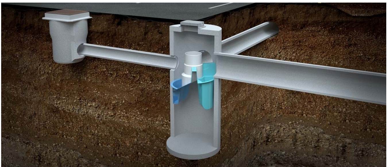
Figura 1 : Aspirazione di liquidi galleggianti e leggeri
