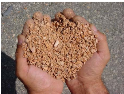
Figura 3 : Gli scarti vengono macinati dalle lame metalliche del mulino.
