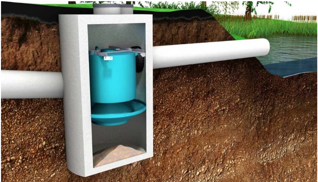
Abb. 1 : Absaugen von Schwimm- und Leichtflüssigkeiten
