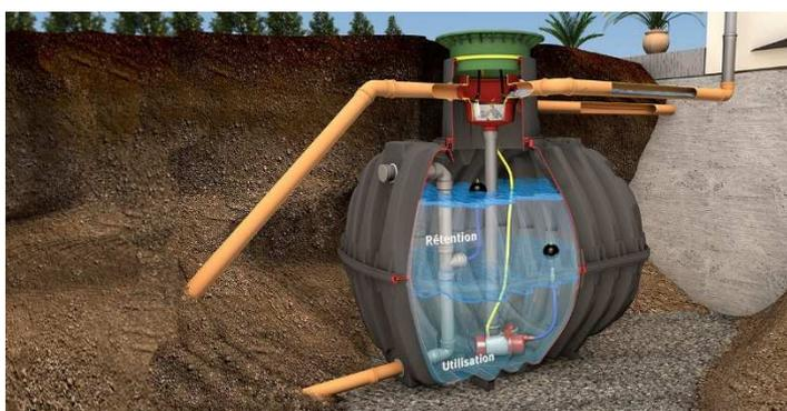
Retenir les eaux pluviales dans sa partie rétention et les évacuer vers le réseau selon un débit régulé par un limiteur de débit.
