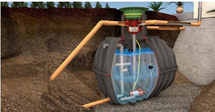
Regenwasser in einem Retentionsabteil sammeln und in Rohrleitungen mit einem per Durchflussregler kontrollierten Abfluss leiten. Einen Teil des Regenwasser für persönliche Nutzung im Garten speichern.
