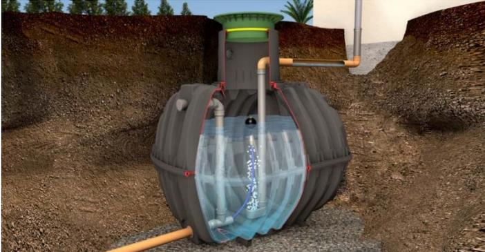
Regenwasser sammeln und in Rohrleitungen mit einem per Durchflussregler kontrollierten Abfluss leiten.
