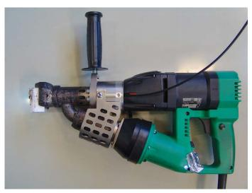
Der Extruder-Schweisskolben wird zum Schweissen von PE (Polyethylen) und PP (Polypropylen) verwendet. Der Rohstoff wird in Form eines Drahtes mit einem Durchmesser von 4 oder 5 mm dazugegeben. Das auf 200-220°C erhitzte Material wird durch die Anlage mittels eines Schneckengetriebes bewegt.
