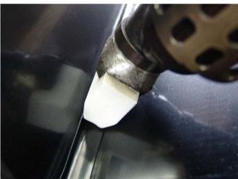
Das Punktieren, welches unter "Schweissen von PVC" beschrieben wird, ist sowohl bei PE und PP, als auch bei PVC notwendig. Bei PE und PP ist ein Aufrauhen der Oberfläche vor dem Schweissen zwingend notwendig.
