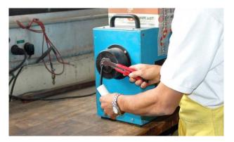
3. Der Extruder erhitzt den dazugegebenen Stoff auf eine Temperatur von ca. 220°C und verleiht ihm eine Würstchenform mittels Düsen unterschiedlicher Grösse. Der Arbeiter befördert diese Schweisswulst ins Innere einer Teflon-Rohrleitung und bringt diese am Träger an.
