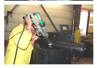
Schweissen eines PE-Schachtbodens mittels eines Extruder-Schweisskolbens. Informationen zum Schweissen in engen Räumen finden Sie in «Schweissen von PE mit Haering<sup>©</sup>-Extruder».
