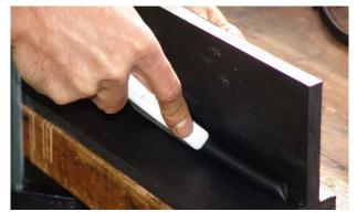
4. Für alle Arten des Kunststoffschweissens müssen Temperaturen der Stütze und dazugegebenen Materials unbedingt identisch sein, und der Anpressdruck muss eingehalten Zu werden. diesem Zweck muss Schweissstelle mit einer Teflon-Spachtel zugedrückt werden.
