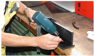
Mittels eines "Föhns" erhitzt der Arbeiter die bereits punktierten Elemente. Seine Erfahrung ermöglicht es ihm, die Temperatur der Stütze zu testen, indem er mit einer Metallspitze auf den Stoff drückt, der sich je nach Hitze erweicht.
