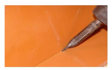
Punktieren ist ein Vorgang, mit dessen Hilfe man für hochwertige Schweissergebnisse sorgt. Dieses Zusammenfügen im heissen Zustand ohne Materialzugabe ermöglicht es, den Raum zwischen einzelnen Elementen zu füllen und diese vor dem Schweissen leicht zu fixieren.
