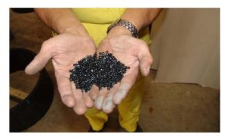
Der Rohstoff hat die Form von PE Granulat (Polyethylen). Er wird in das Silo gegeben, das sich über dem Extruder befindet.
