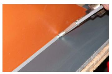
3. Der auf den Ring und die Schweissspitze ausgeübte Druck schafft ausreichenden Druck auf die Schweissspitze, womit für hervorragende Haftung gesorgt wird. Die orange oder graue Farbe des PVC spielt beim Schweissen keine Rolle, denn es handelt sich einfach um dasselbe Material mit verschiedenen Farbstoffen.
