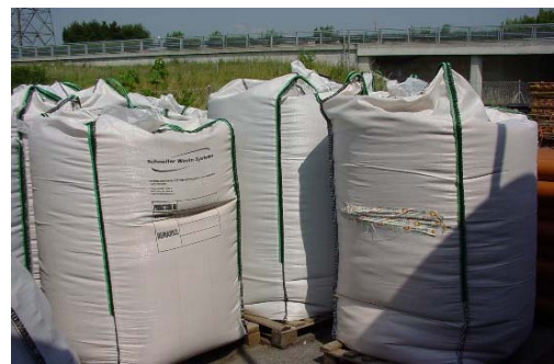
Figura 5 : I sacchi vengono immagazzinati e poi trasportati verso le fabbriche dei tubi. Un ultimo trattamento del materiale riciclato sarà eseguito in fabbrica prima della miscela con la materia prima.
