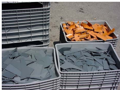
Figura 1 : Separazione degli scarti di PVC in base al materiale e al colore. I tubi e le placche sono tagliati a pezzi.
