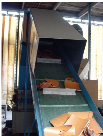
Figura 2 : Il nastro trasportatore alimenta il mulino.
