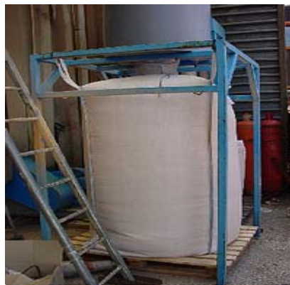
Figura 4 : Una ventola spinge il materiale macinato nei sacchi.
