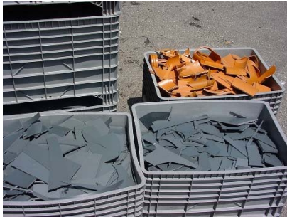
Figure 1 : Tri des déchets de PVC selon la matière et la couleur. Les tuyaux et plaques sont découpés en morceaux.
