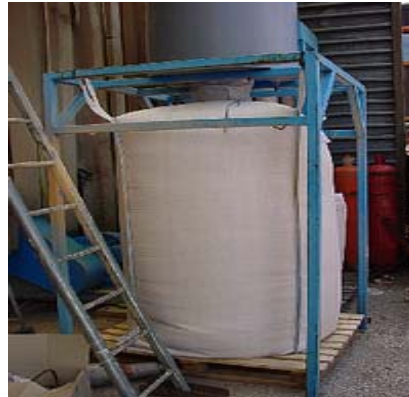
Abb. 4 : Die zerkleinerten Materialien werden mithilfe eines Lüfters in Säcke geschleudert.
