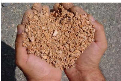
Abb. 3 : Die PVC-Abfälle werden durch die Metallschneiden der Zerkleinerungsmaschine zerkleinert.
