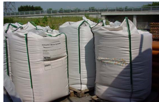
Abb. 5 : Wenn die Säcke voll sind, werden sie zur Rohrfabrik transportiert. Die letzte Behandlung des recycelten Materials erfolgt in der Fabrik vor dem Vermischen mit dem Rohstoff.
