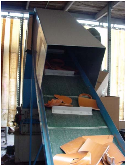
Abb. 2 : Der Transport zur Zerkleinerungsmaschine erfolgt mittels eines Förderbandes.
