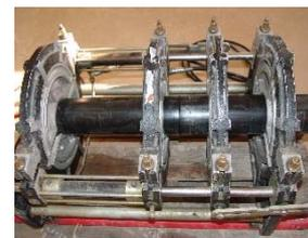
Anche se non è normalizzata per il PVC, questa tecnica di saldatura dà ottimi risultati per particolari applicazioni eseguite in officina.
