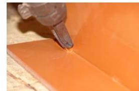
Questo tipo di estrusore permette di saldare tra di loro PE e PP. Il materiale di apporto è in forma granulare. Questo sistema permette di scegliere la larghezza del cordone di saldatura e di accedere ad aree di accesso limitato. Vedere anche 'Saldatura del PE con l'estrusore Haering®' più avanti in questo capitolo.
