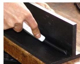
Questo tipo di pistola-estrusore permette la saldatura tra di loro PE, PP e PVC. Il materiale di apporto è sotto forma di filo di sezione circolare. Questo sistema permette di scegliere la larghezza del cordone di saldatura. Vedere anche 'Saldatura del PE e del PP con una pistola a estrusione' più avanti in questo capitolo.
