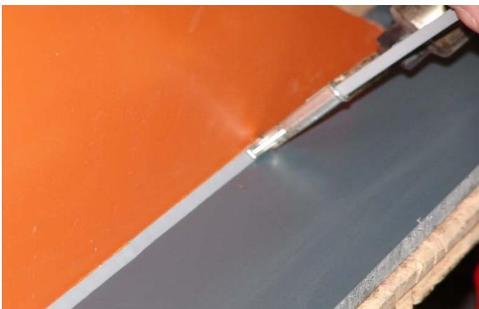
3. La pression exercée sur la baguette et le bec à souder crée une pression suffisante sur le support pour obtenir une excellente adhérence. La couleur orange ou grise du PVC ne joue pas de rôle pour la soudure car il s'agit de la même matière avec simplement un colorant différent.
