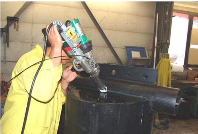
3. Soudure d'un fond de chambre en PE avec un pistolet-extrudeur.
