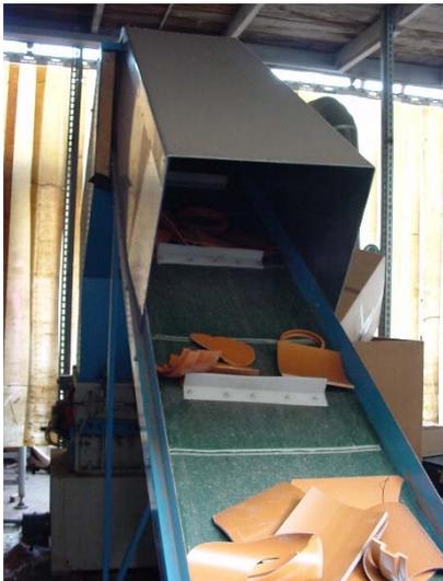
**Figure 2 :** Le tapis roulant alimente le broyeur.
