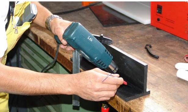
2. L'ouvrier chauffe à l'aide d'un « foehn » les éléments déjà pointés (*pointage voir 'Soudure du PVC'*). Son expérience lui permet de tester la température du support en appuyant une pointe métallique sur la matière qui se ramollit en fonction de la chaleur.
