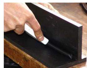
Ce type de pistolet-extrudeur permet de souder entre autres le PE, et le PP et le PVC. Le matériau d'apport est sous forme de fil à section circulaire. Ce système permet de choisir la largeur du cordon de soudure. Pour plus de détails, voir « Soudure avec pistolet-extrudeur » plus loin dans ce chapitre.
