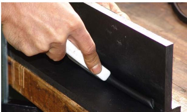
4. Pour tous les types de soudures en matières plastiques, il est important que la température du support et de la matière d'apport soient identiques et que la pression de contact soit respectée. Pour cela, on écrase la soudure avec une spatule en Teflon.
