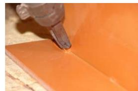
Ce type d'extrudeuse permet de souder entre autres le PE, et le PP. Le matériau d'apport est sous forme de granulés.
