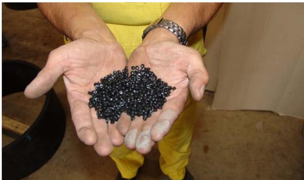
1. La matière première se présente sous forme de granulé de PE (polyéthylène) sur cette photo. Elle est placée dans le silo qui est disposé sur l'extrudeuse.
