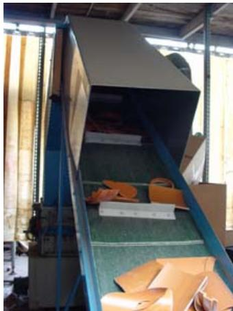
**2.** Il nastro trasportatore alimenta il mulino
