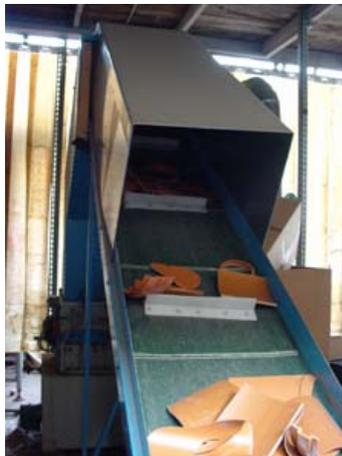
**2.** Il nastro trasportatore alimenta il mulino
