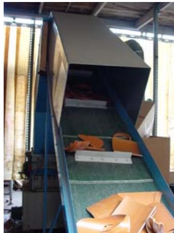
**2.** Il nastro trasportatore alimenta il mulino
