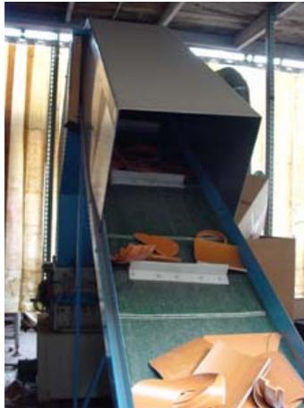
**2.** Il nastro trasportatore alimenta il mulino
