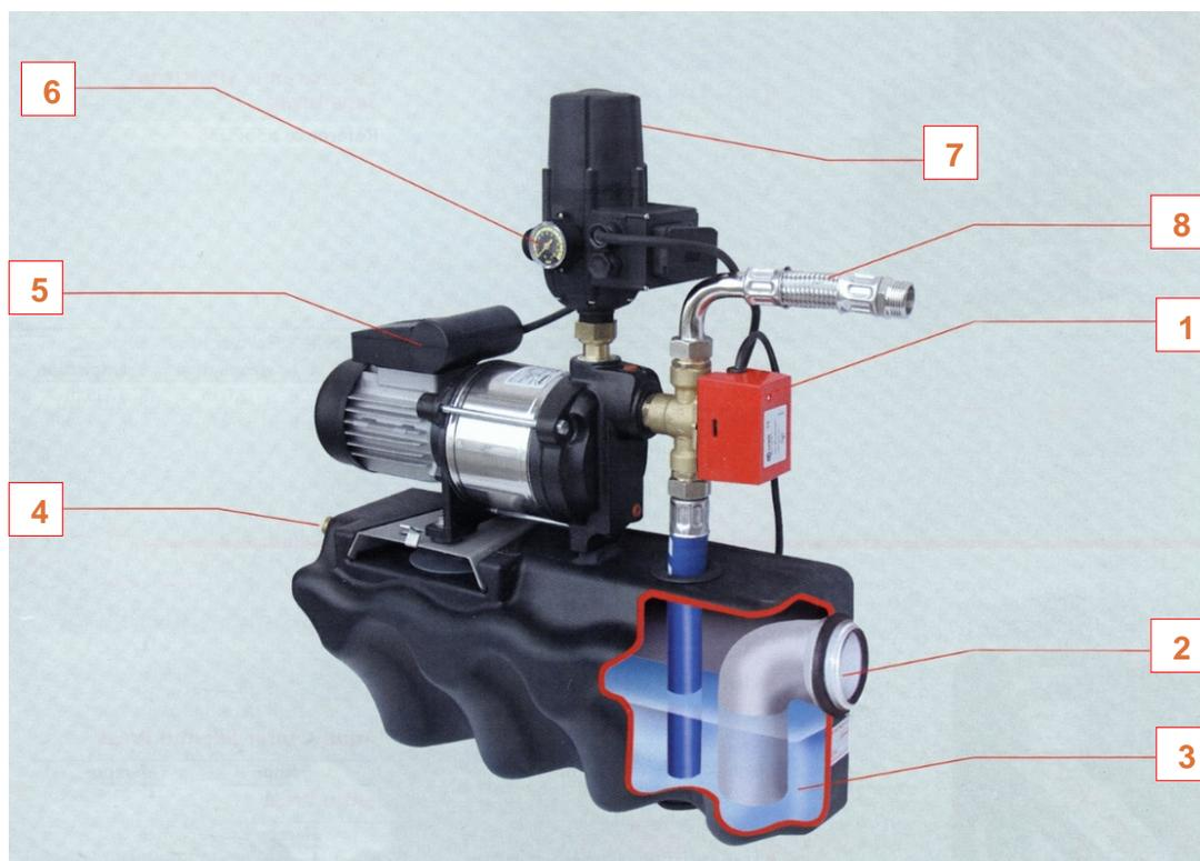
L'impianto d'alimentazione completo è pre-montato comanda, tutta la vostra installazione. Permette di supplire alla mancanza d'acqua piovana commutando automaticamente sulla rete idrica grazie a una valvola a 3 vie. Quando il galleggiante all'interno del serbatoio segnala nuovamente la presenza d'acqua piovana l'impianto ritorna automaticamente ad usarla
