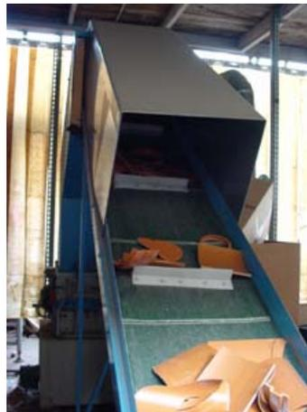
**2.** Il nastro trasportatore alimenta il mulino
