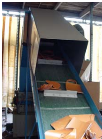
2. Il nastro trasportatore alimenta il mulino
