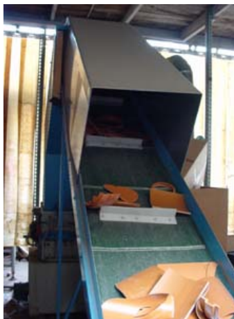
2. Il nastro trasportatore alimenta il mulino
