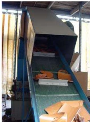
**2.** Il nastro trasportatore alimenta il mulino
