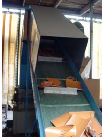
2. Il nastro trasportatore alimenta il mulino
