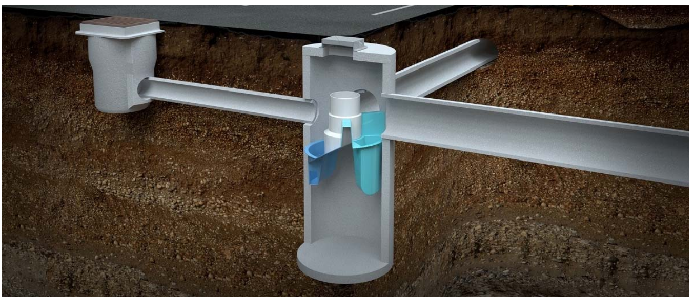
Figura 1 : Aspirazione di liquidi galleggianti e leggeri
