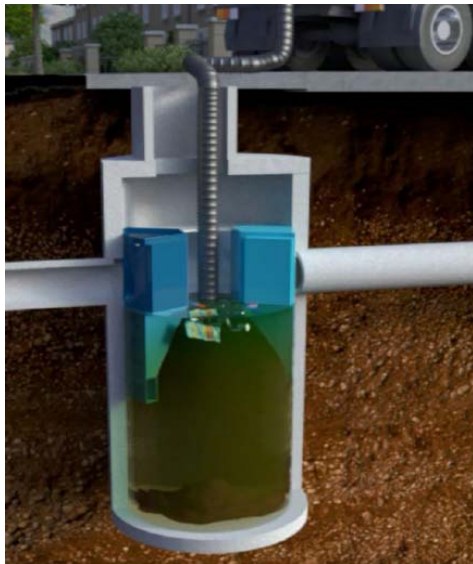
Abb. 1 : Absaugen von Schwimm- und Leichtflüssigkeiten
