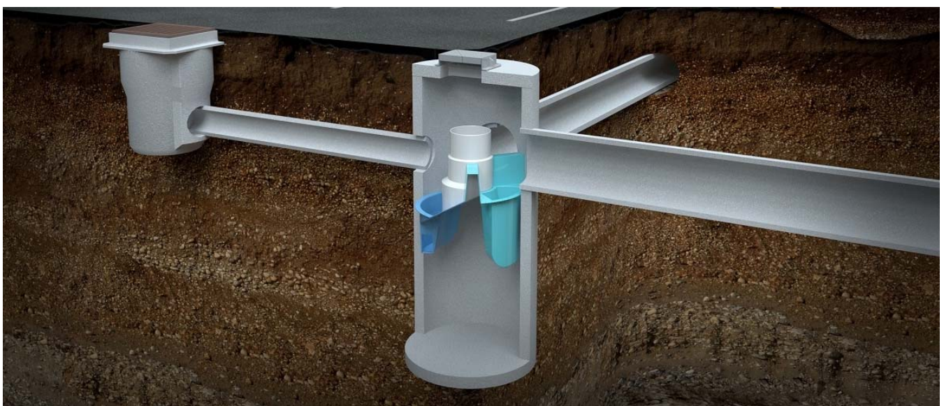
Abb. 1 : Absaugen von Schwimm- und Leichtflüssigkeiten
