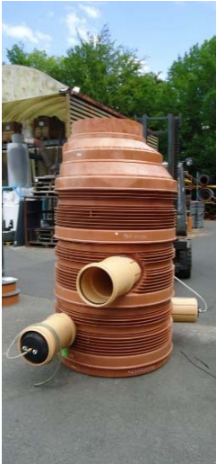
Figure 3 : Obturation de la chambre pour contrôle.
