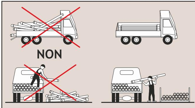
Fig. 5 - Transport et déchargement.
