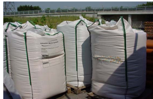
Figure 5 : Les sacs sont stockés puis transportés vers la fabrique de tuyaux. Un dernier traitement de la matière recyclée sera effectué en usine avant le mélange avec de la matière première.
