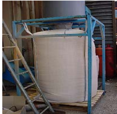
Figure 4 : Un ventilateur propulse les matériaux concassés dans des sacs.
