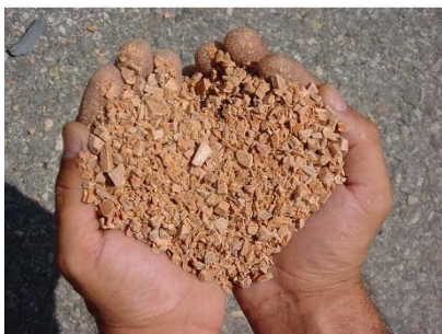
Figure 3 : Les déchets de PVC sont concassés par les couteaux métalliques du broyeur.
