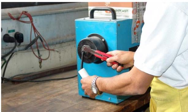
3. L'extrudeuse chauffe la matière d'apport à une température de 220°C environ et la propulse en forme de saucisse par une buse de diamètre variable. L'ouvrier transporte ce cordon de soudure à l'intérieur d'un tuyau en Teflon et l'applique sur le support.
