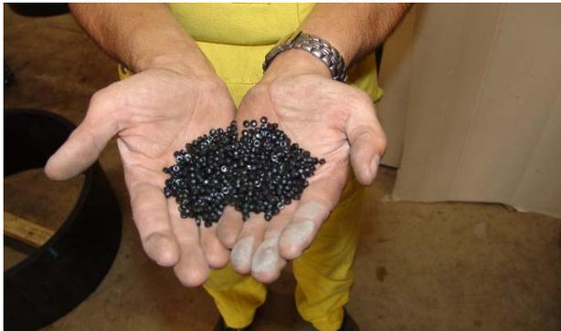
1. La matière première se présente sous forme de granulé de PE (polyéthylène) sur cette photo. Elle est placée dans le silo qui est disposé sur l'extrudeuse.
