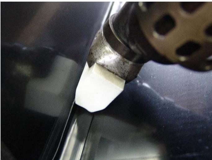
2. Le pointage, décrit dans 'Soudure du PVC', est nécessaire aussi bien pour le PE et le PP que pour le PVC.
