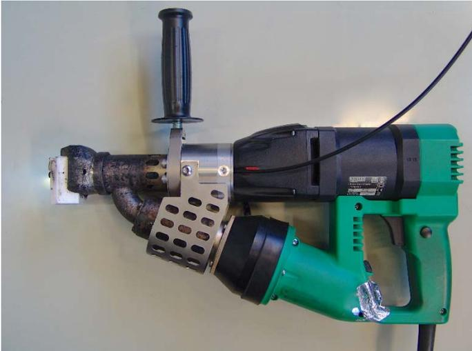
1. Ce pistolet-extrudeur est utilisé pour la soudure du PE (polyéthylène) et du PP (polypropylène). Il est alimenté en matière première par un fil de 4 ou 5 mm de diamètre. La matière, chauffée entre 200 et 220°C, est propulsée à travers l'appareil par une vis sans fin.
