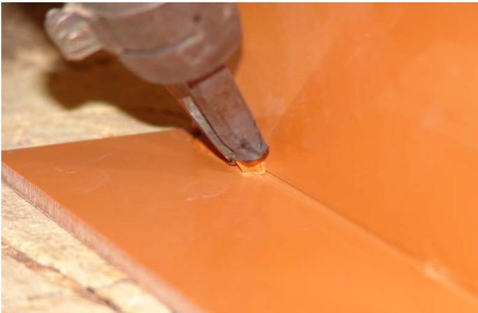
2. La soudure se fait avec un bec approprié. La matière d'apport est une baguette triangulaire. L'air à plus de 300°C produit par l'appareil chauffe simultanément la face inférieure de la baguette et la face supérieure du support.
