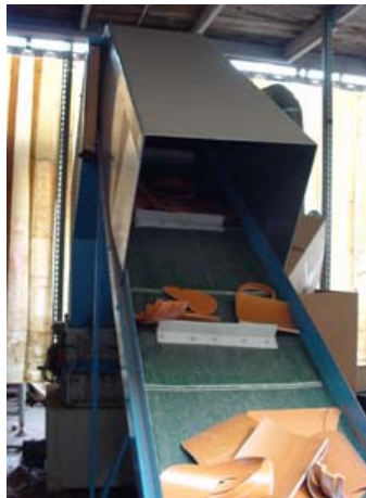
2. Il nastro trasportatore alimenta il mulino
