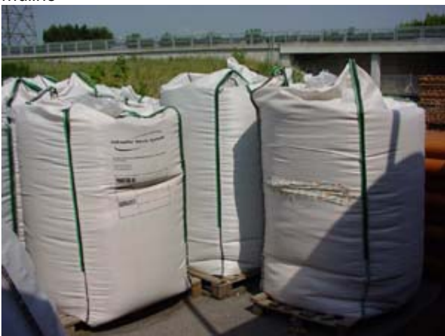
5. I sacchi vengono immagazzinati e poi trasportati verso le fabbriche dei tubi. Un ultimo trattamento del materiale riciclato sarà eseguito in fabbrica prima della miscola con la materia prima
