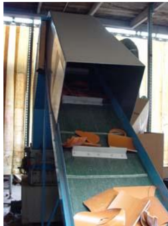
2. Il nastro trasportatore alimenta il mulino
