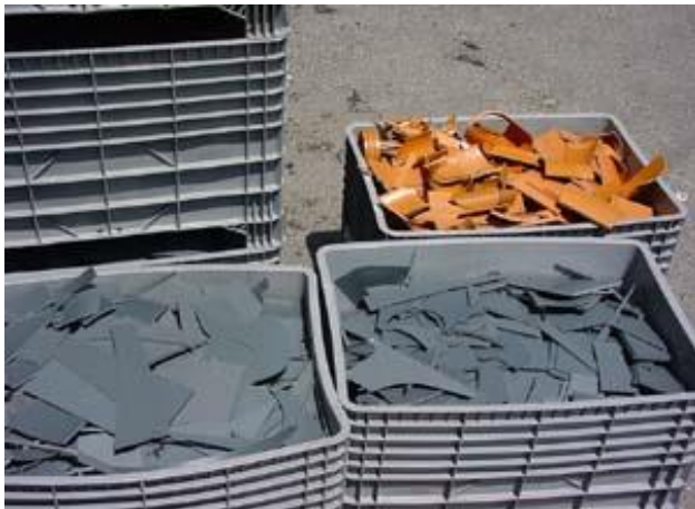
1. Separazione degli scarti secondo il materiale e il colore. I tubi e le placche sono tagliati a pezzi
