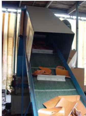
2. Il nastro trasportatore alimenta il mulino
