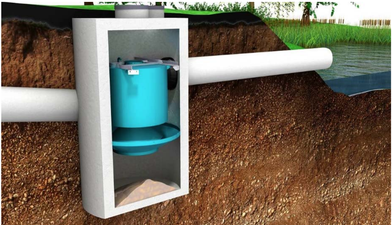
Figure 1 : Aspiration des flottants et liquides légers
