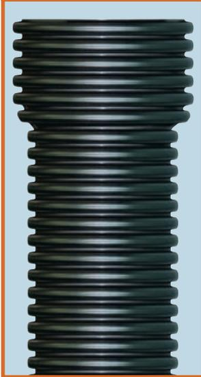
TWIN ECO SN8 est le nouveau tube annelé en PP (polypropylène à haut module), double paroi, dimensionné sur le diamètre intérieur, pour conduites d'évacuation enterrées sans pression conforme à la norme NF EN 13476-3 et règlement particulier de la marque NF 442. Le caractère innovant consiste en son système de jonction conçu directement sur la barre tout en maintenant le profil du tube conservant ainsi les mêmes caractéristiques mécaniques de résistance.
