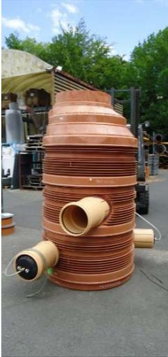
**Figure 3 :** Obturation de la chambre pour contrôle.
