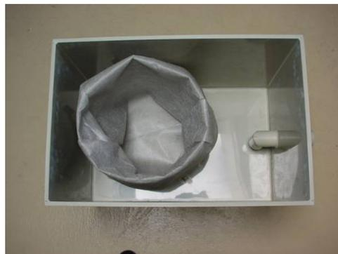
Pour procéder à une floculation, il suffit de mettre un ajout de poudre (floculant) dans l'eau à traiter, de brasser quelques minutes et une fois les floccs formés de laisser l'eau passer par le filtre. Cette manipulation prend env. 5 min. La dose moyenne de poudre utilisée est d'env. 100 gr par 100 litres d'eau à traiter.
