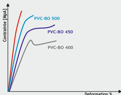
La courbe contrainte déformation du PVC Bi-orienté est similaire à la courbe caractéristique des métaux et change radicalement par rapport au comportement des plastiques traditionnelles. La transformation complète des propriétés mécaniques du PVC Bi-orienté par rapport au PVC conventionnel ne s'obtient que pour les classes les plus élevées de la biorientation (PVC-BO 450 et PVC-BO 500) comme celles des tuyaux SupertuBO.
