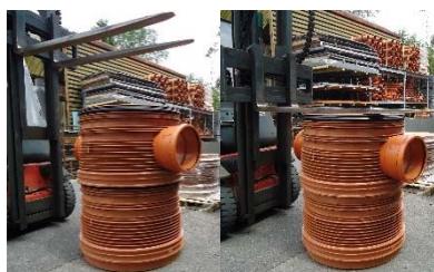
Insertion de la rehausse (point 5)
