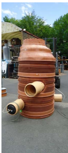
Figure 3 : Obturation de la chambre pour contrôle.
